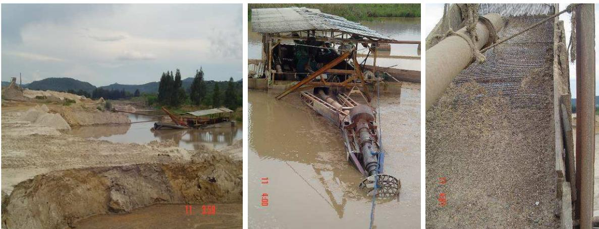
Figura 12: Extração e peneiramento simples de areia de cava submersa.
