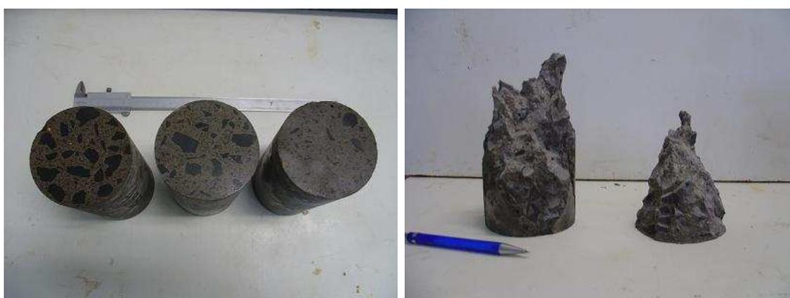
Figura 31: Corpos-de-prova antes e depois do rompimento.
