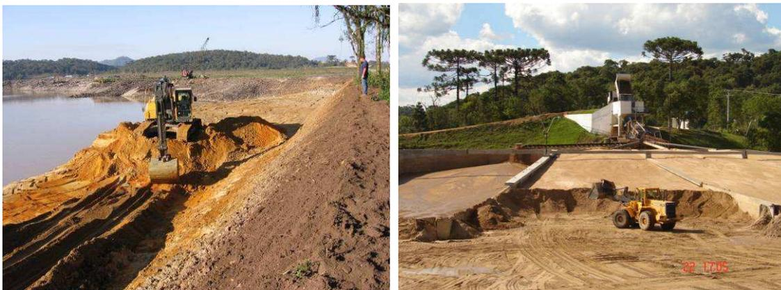
Figura 19: Extração e depósito da areia após a lavagem.
