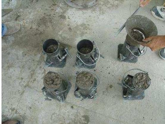
Figura 29: Moldagem de corpos-de-prova.
