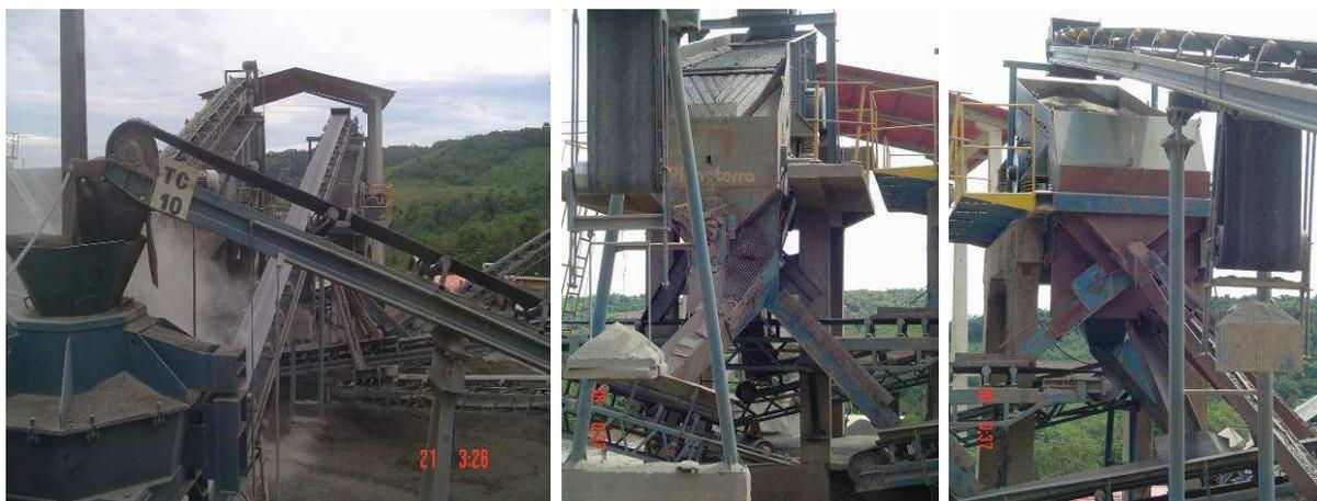
Figura 6: Peneiras vibratórias para classificação do material
