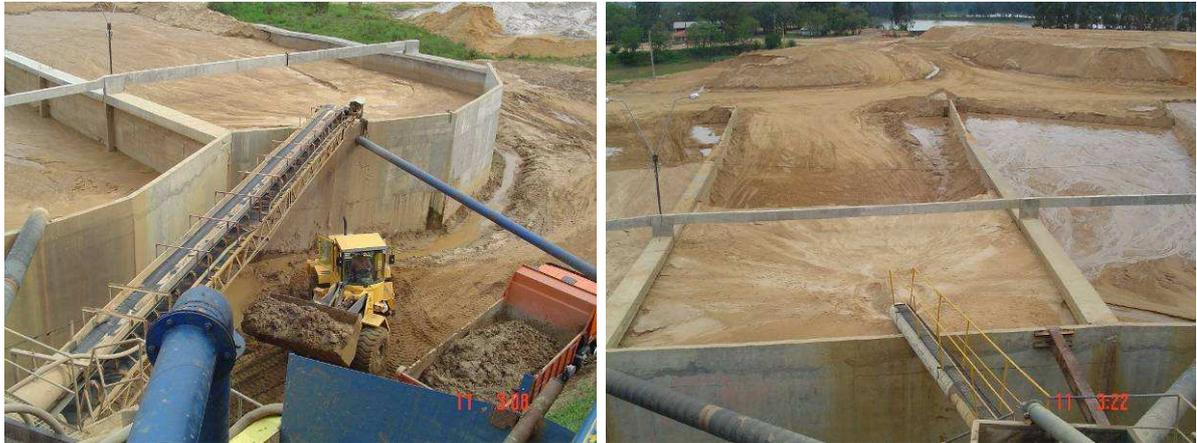
Figura 11: Expedição de cascalho e acomodação em canchas para secagem e expedição da areia de cava seca.
