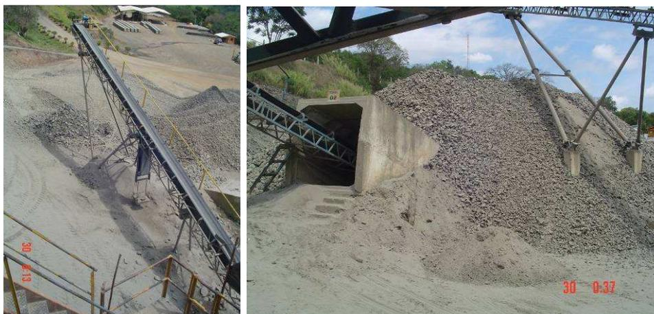
Figura 4: Correias transportadoras e pilhas pulmão
