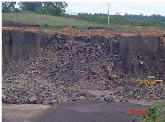
Figura 1: Encosta e material do desmonte
