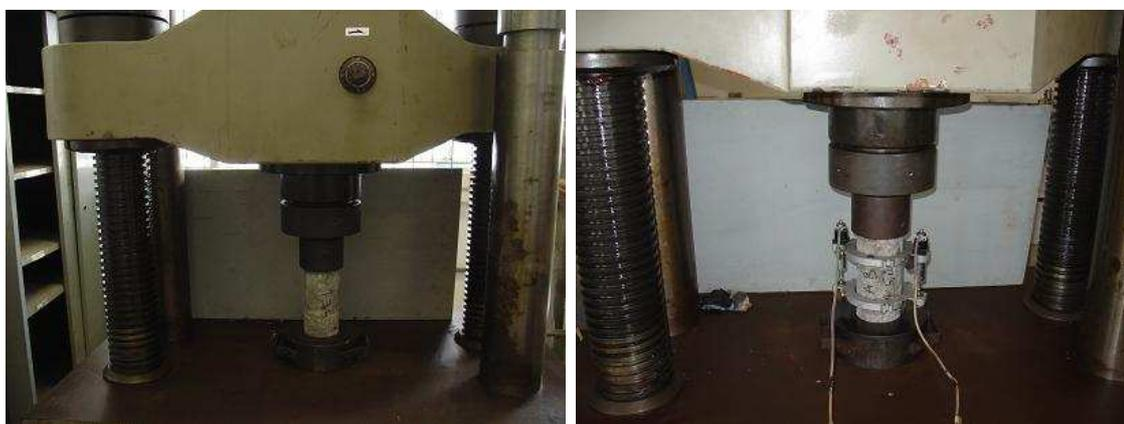
Figura 30: Ensaio de resistência à compressão e módulo de elasticidade dos corpos-de-prova.
