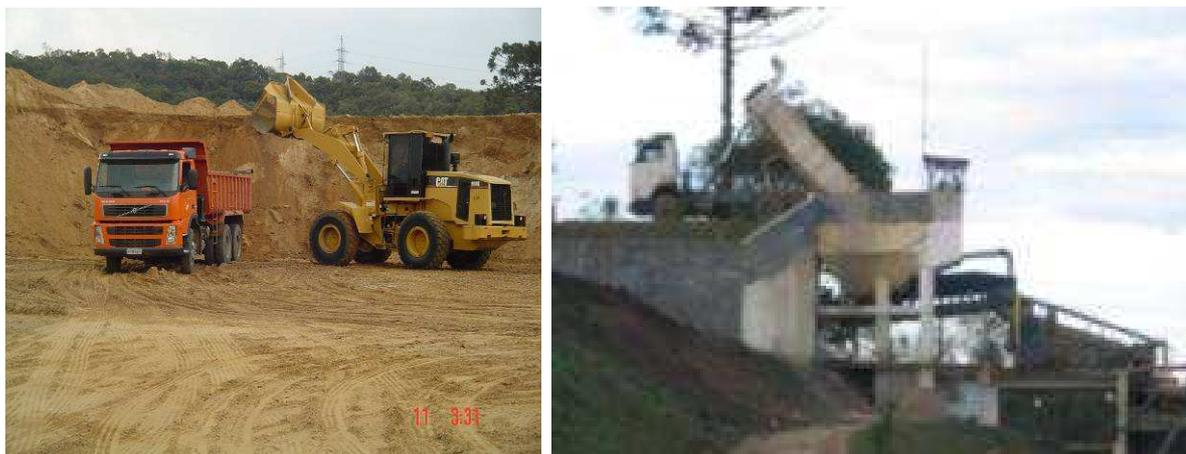
Figura 9: Extração de areia natural de cava seca com equipamento mecânico.
